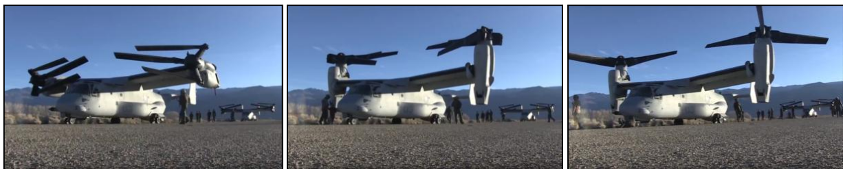
FIGURE 2 - Déploiement des moteurs, puis des pales
