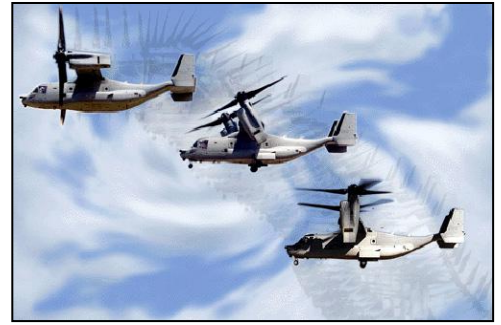
FIGURE 1 - Un V-22 Osprey, passant du mode « hélicoptère » au mode « avion »
